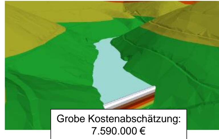
Variante II: Bau eines Hochwasserrückhaltebeckens
